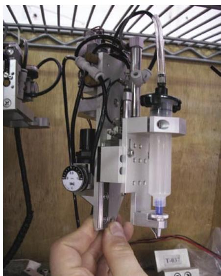
Рис. 8. Дозатор
